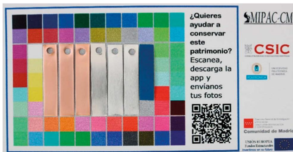
**Figura 5.** Ejemplo de panel con la carta de referencia y las probetas de plata y cobre que actúan como dosímetros para poder llevar a cabo la monitorización
