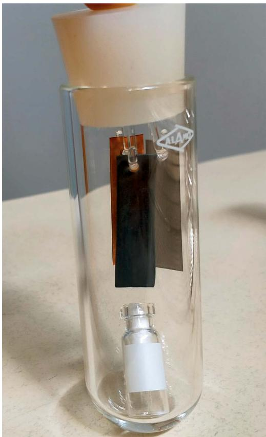
**Figura 3.** Prototipo de tubo «3 en 1» para realizar el test de Oddy. Preparación de un test blanco de referencia
