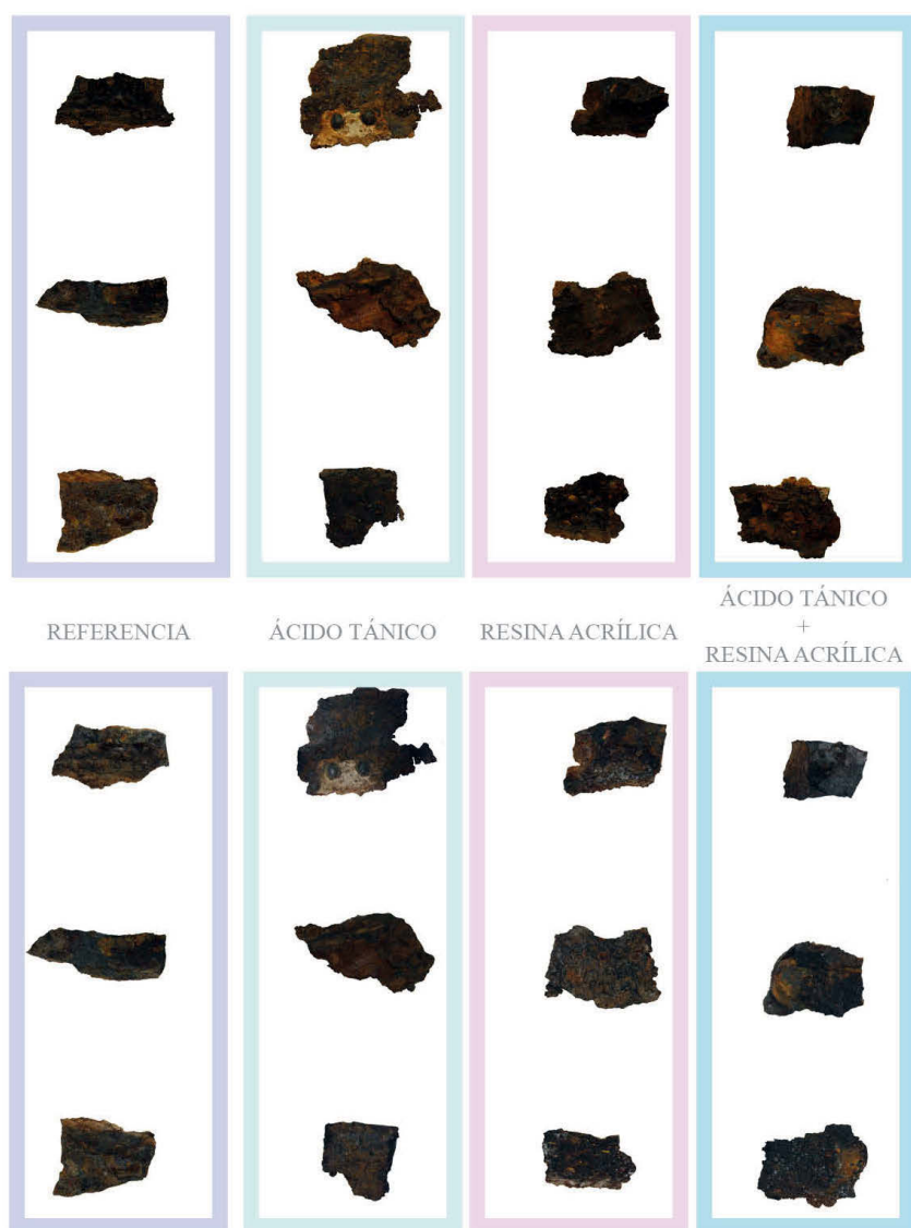
Figura 1. Piezas antes y después de la aplicación de los tratamientos
