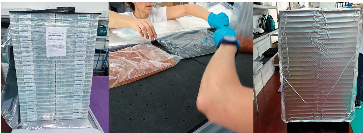
**Figura 3.** Almacenamiento temporal en palés conteniendo bandejas con monedas o bloques, reguladores de HR, absorbentes de VOC y encapsulado con plástico multicapa
