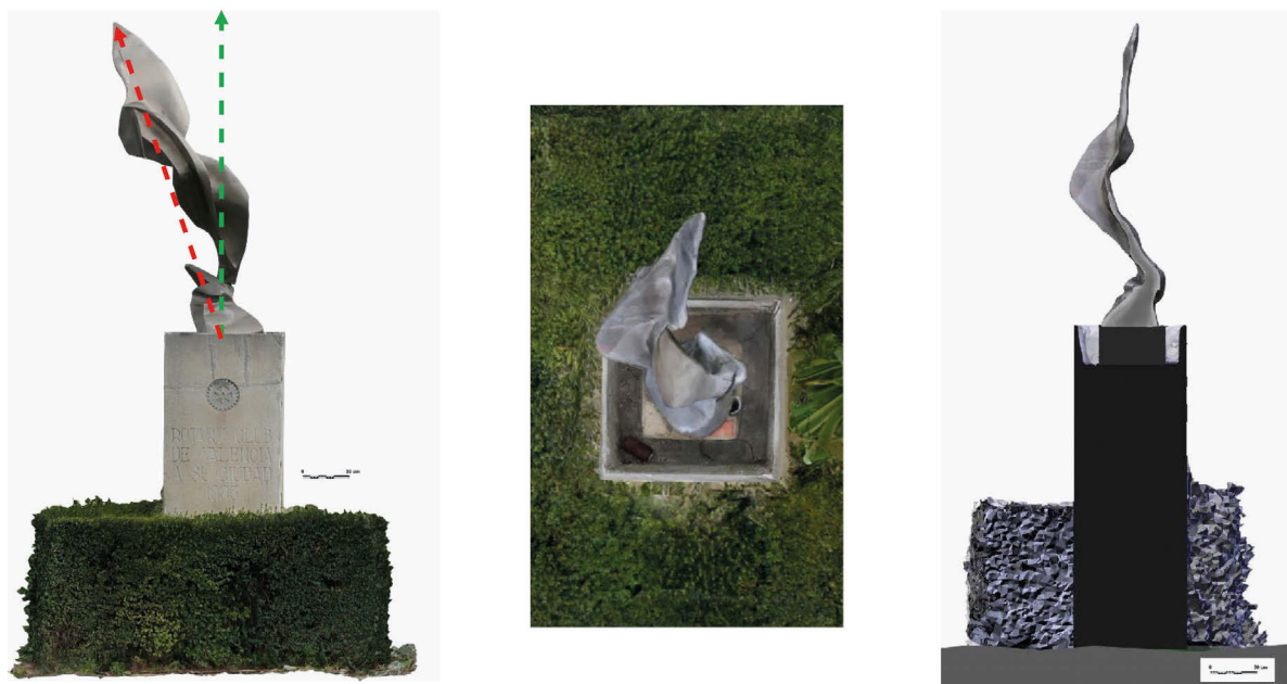
Figura 3. Resultado del estudio fotogramétrico que permitió tener a escala alzados ortogonales, planta, sección y modelo en 3D de la escultura
