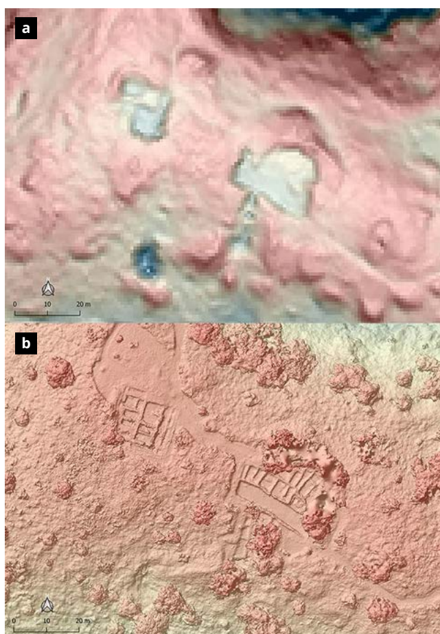
Figura 6. Comparación entre los diferentes modelos digitales: a) modelo digital del terreno construido a partir de datos LiDAR del IGN; b) modelo digital del superficie construido a partir de imágenes tomadas con dron. © Grupo de investigación Oppiduum
