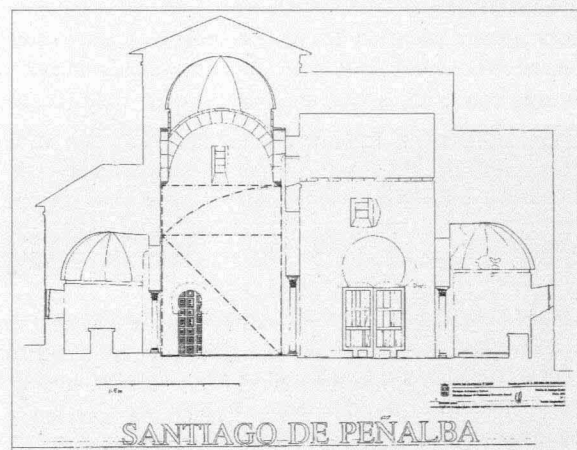
Fig. 3. La planta y la sección longitudinal de Santiago de Peñalba y su análisis. (Los planos facilitados por el arquitecto A. Fernández Muñoz).
