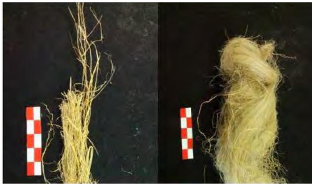
Fig. 14: fibras vegetales que se pueden emplear como el esparto o el cáñamo, respectivamente.
