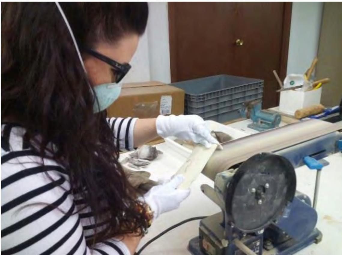
Figura 8. Proceso de lijado/alisado de espátulas con una lijadora de bandas.
