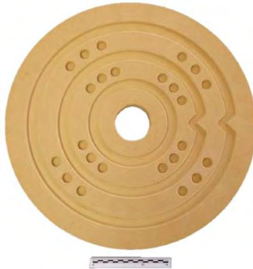
Fig. 12. Molde de madera en negativo para la elaboración de escudos de piel
