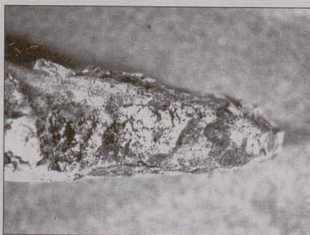
Figura 17. Martillo Tajadera (pico). Análisis de MEB con EDX, y detalle óptico del foco de corrosión en la punto donde había inclusiones de Pb.
