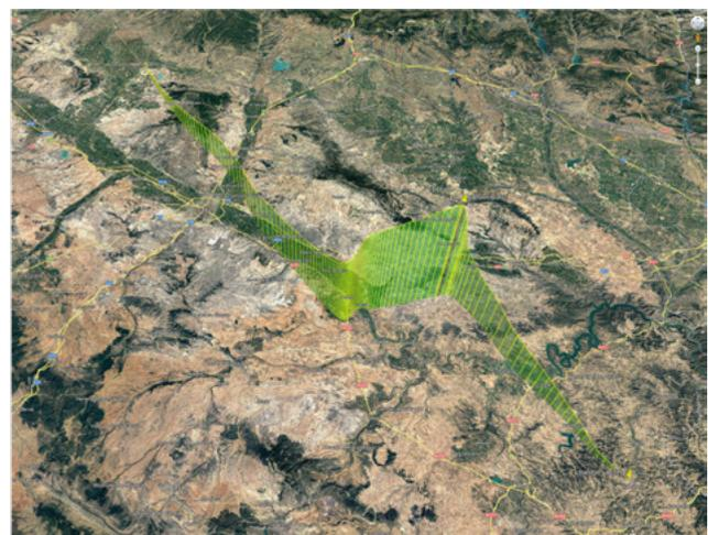
FIGURA 6. Trayectoria real del globo-sonda registrada mediante el sistema APRS y su proyección en Google Earth.
